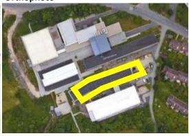
Fläche für PV verfügbar Neigung Strombezug 2022 Grundlast in der Nacht Statische Beurteilung Notizen 600 m<sup>2</sup> 0° 171.000 kWh 13 kW
