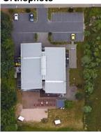
Fläche für PV verfügbar Neigung Strombezug 2022 Grundlast in der Nacht Statische Beurteilung Notizen 256 m<sup>2</sup> 11° Ost/West 57.000 kWh
