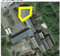
Fläche für PV verfügbar Neigung Strombezug 2022 Grundlast in der Nacht Statische Beurteilung Notizen 380 m² 14° Ost-West 81.160 kWh 6 kW PV-Anlage vollflächig möglich
