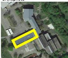
Fläche für PV verfügbar Neigung Strombezug 2022 Grundlast in der Nacht Statische Beurteilung Notizen 160 m<sup>2</sup> 13° Nord 81.160 kWh 6 kW
