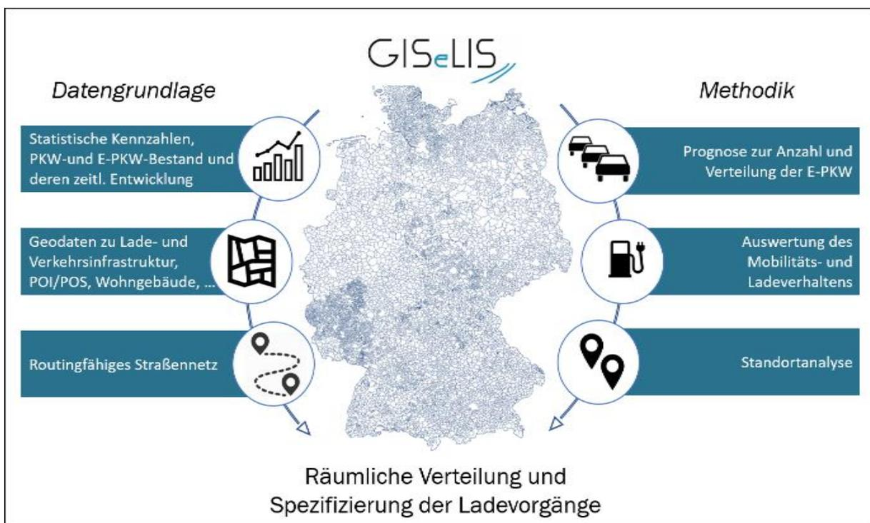
Abbildung 15: Funktionsweise des Standortmodelles für Ladeinfrastruktur *GISeLIS*
