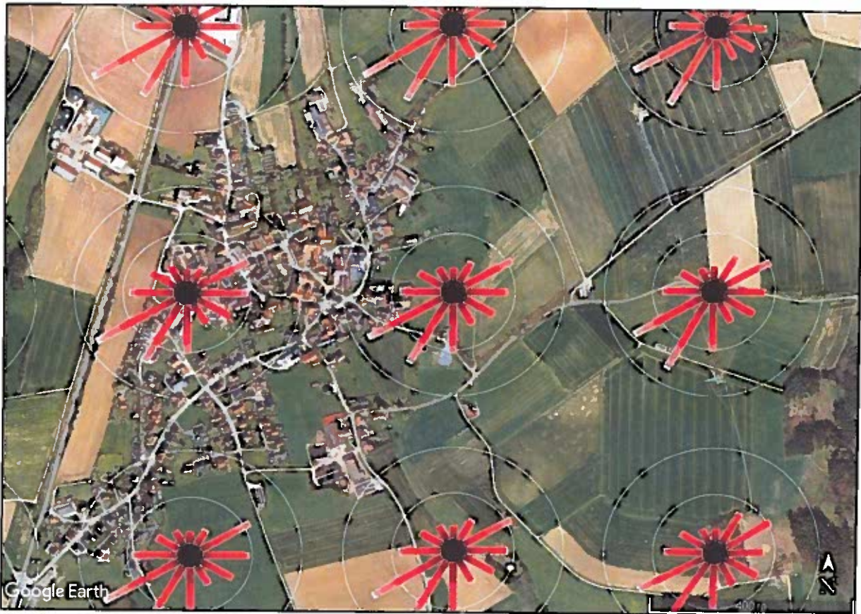
Abbildung 12: Windrichtungsverteilung als abgeschätzte Erwartungswerte für die EAP aus einer prognostischen Modellrechnung
